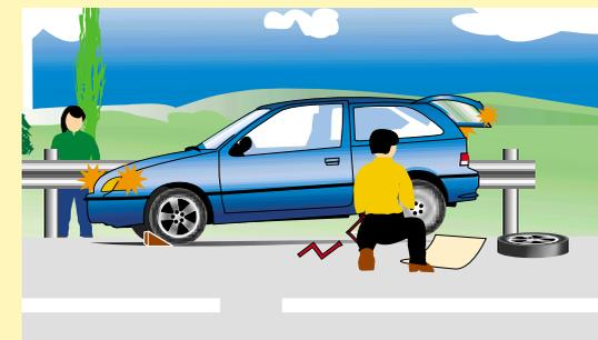
**4 - Déposez la roue crevée. Présentez la roue de secours sur le moyeu. Serrez légèrement les écrous en centrant la roue.**
