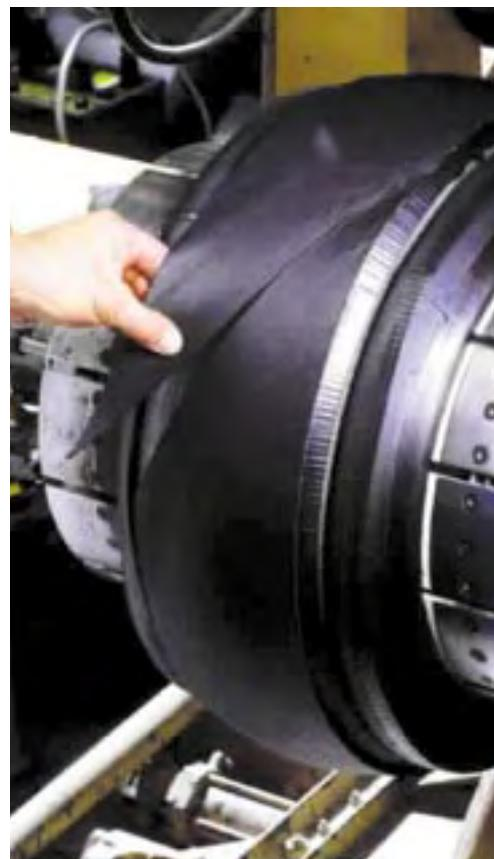
tend et bombe les couches de gomme, dans la limite de la longueur des câbles des nappes. Compte tenu des fortes déformations imposées par cette étape, l'adhésion entre les éléments assemblés doit être assurée.
