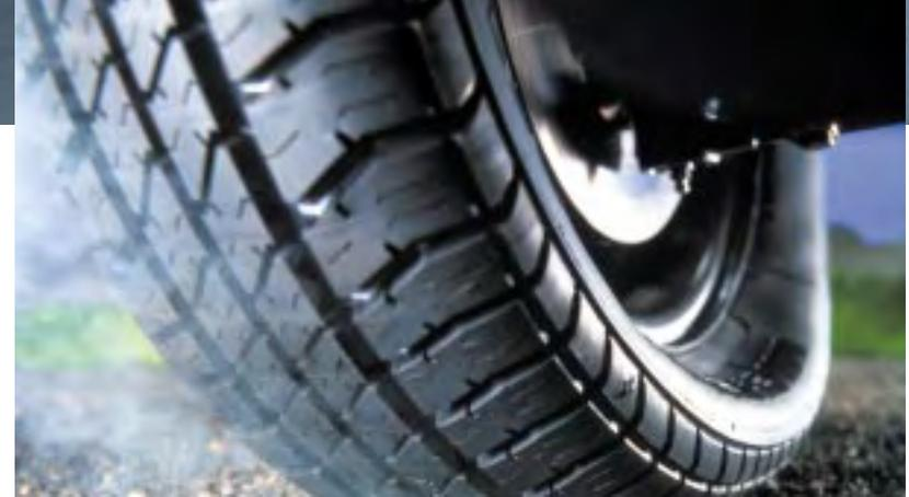
*Un virage pris au maximum de la poussée transversale avec une pression de gonflage insuffisante.*
