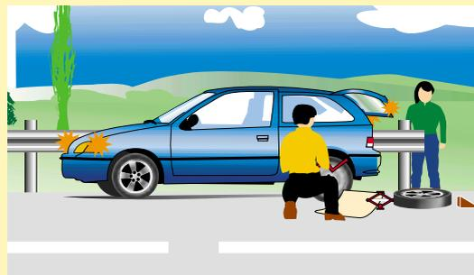
**5 - Descendez la voiture et retirez le cric. Bloquez fermement les écrous avec la clé. Rangez matériel et roue crevée dans le coffre.**
