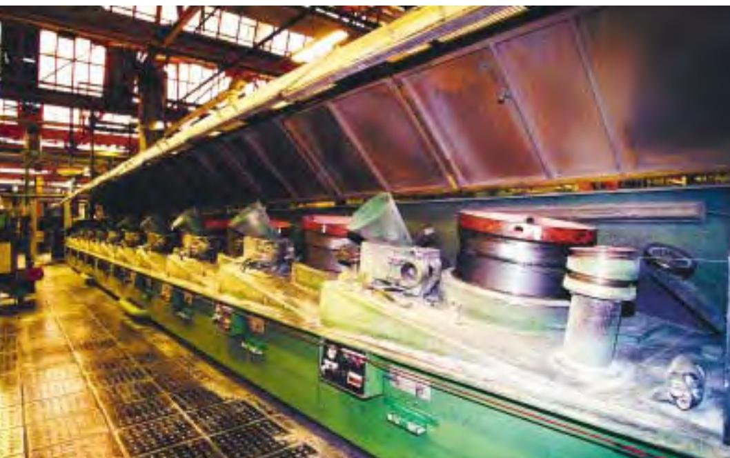
Ligne de tréfilage du fil machine (du diamètre de 5,5 mm jusqu'au diamètre de 1,5 mm).
