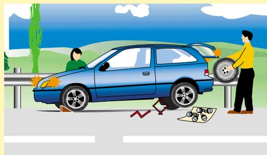
**3 - Soulevez la voiture jusqu'au décolllement de la roue du sol. Enlevez les écrous et placez-les sur un endroit propre.**
