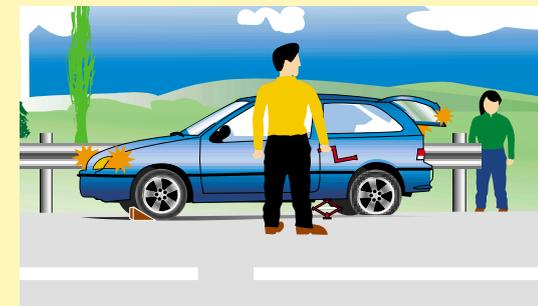
**2 - Calez une des roues. Placez le cric à l'emplacement prévu à proximité de la roue crevée. Débloquez les écrous sans les retirer.**
